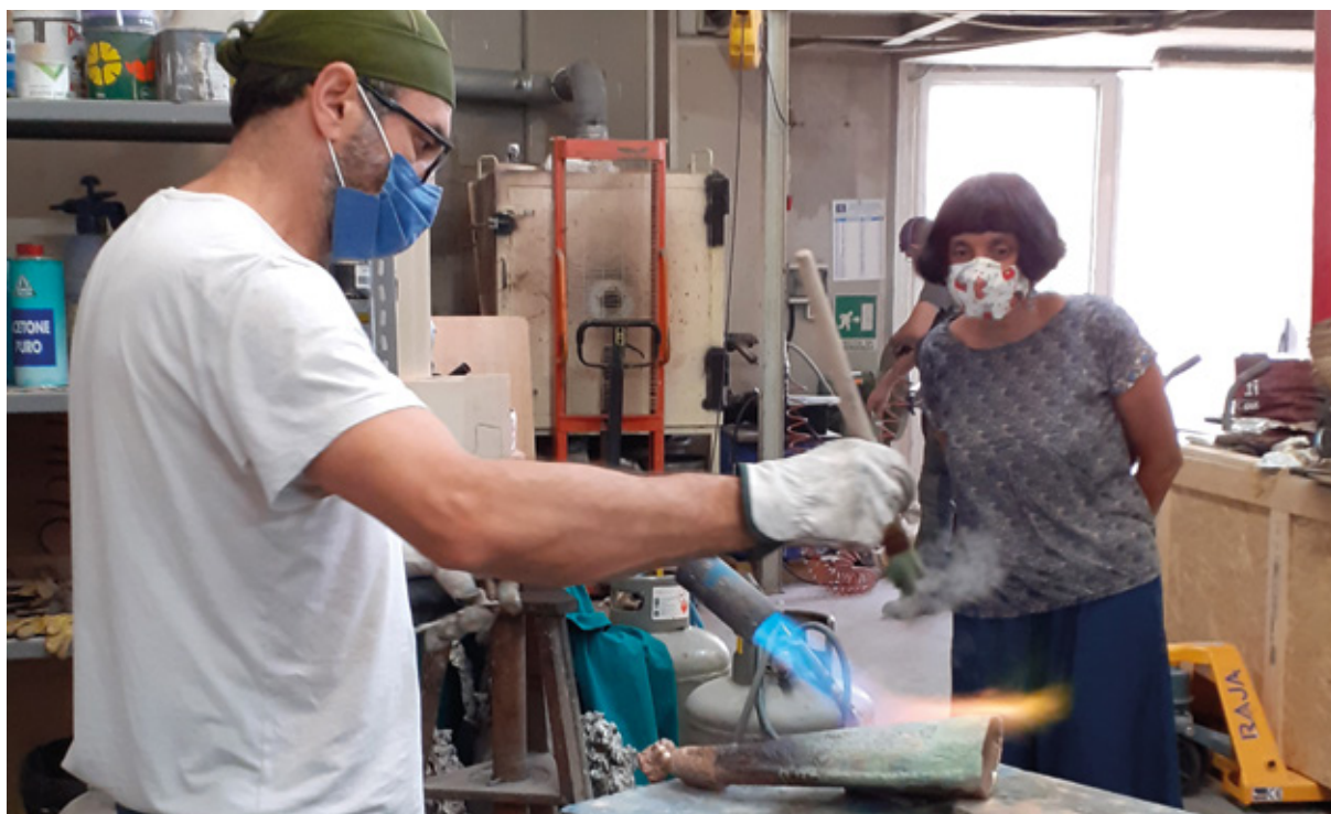
Fase della patinatura con nitrato di rame
